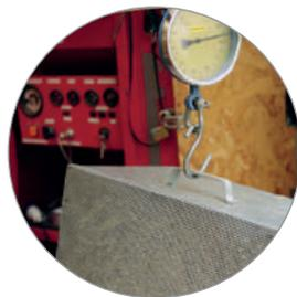
Dichtebestimmung mit Hilfe des Prüfkorb
